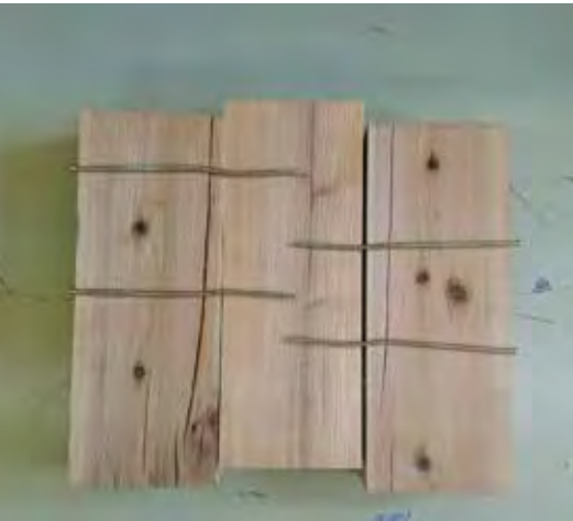
せん断試験後の試験体の様子
