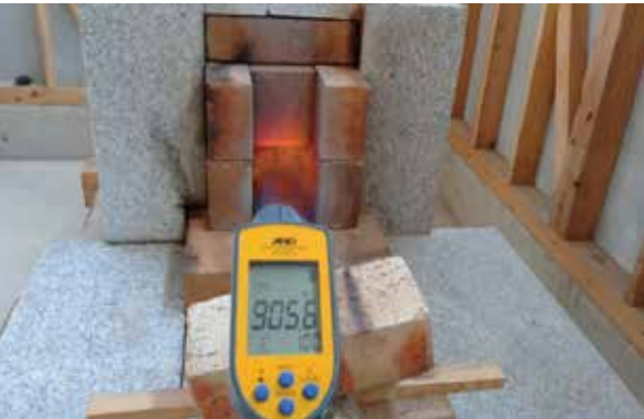
要素試験 (A) 装置炉内温度
