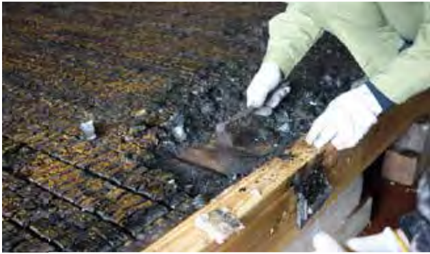
燃焼試験後の解体・観察の様子
