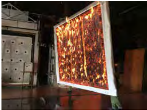
燃焼試験直後の様子
