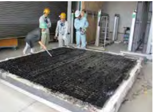
燃焼試験後の解体・観察の様子
