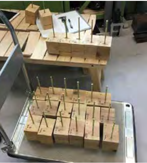
引抜強度試験体
