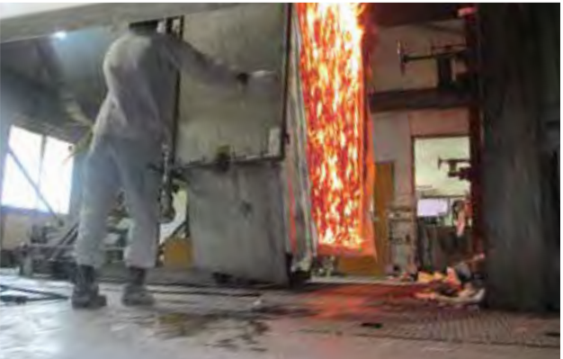
燃焼試験直後の様子
