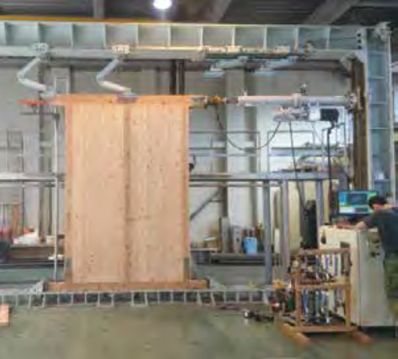
国土交通大臣認定（壁倍率）試験の様子
