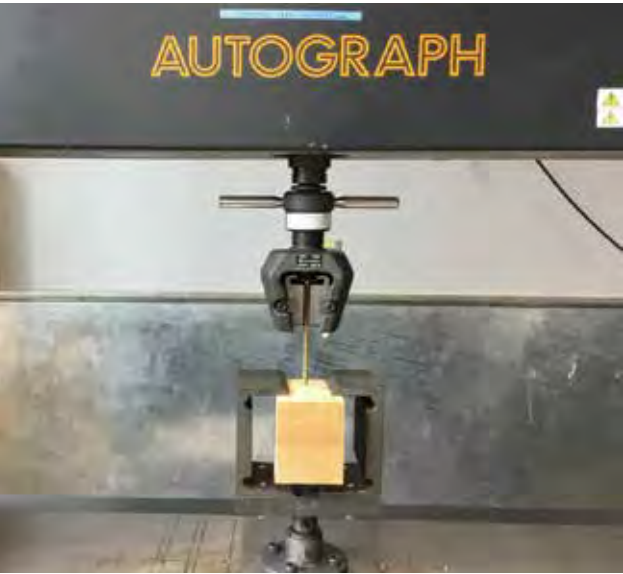
引抜強度試験の様子
