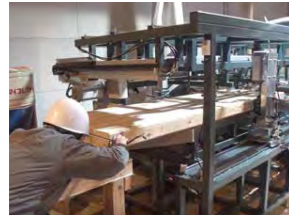
パネルログの幅の寸法確認
