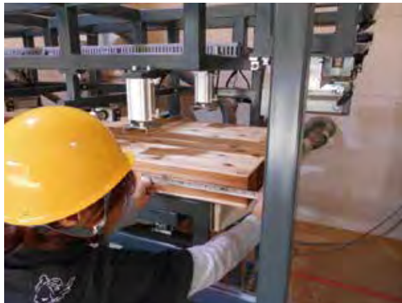
仕様に応じてパネルログの切断位置を確認
